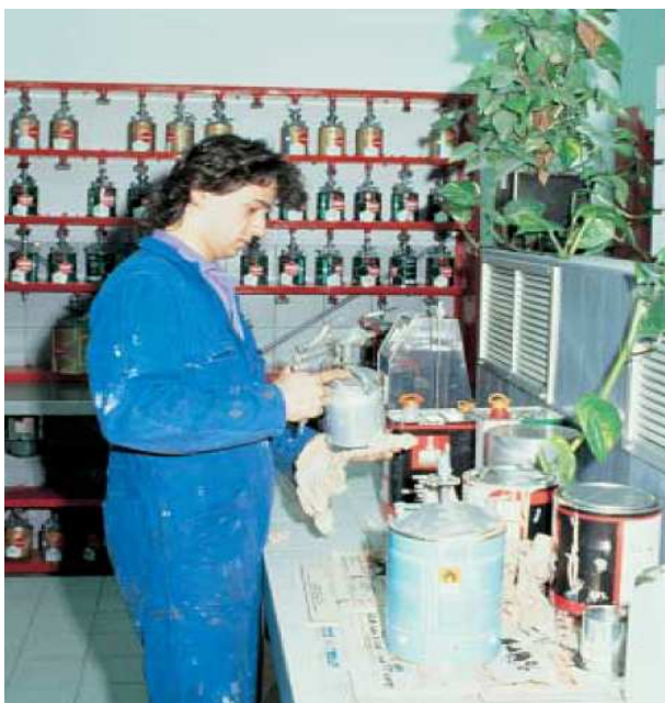
Poste de préparation des peintures avec aspiration frontale
