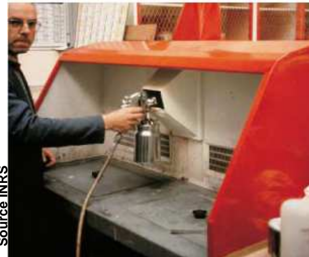
Poste de nettoyage avec aspiration frontale
